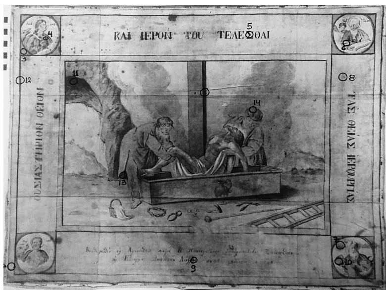
Εικ. 26. Τα σημεία στα οποία πραγματοποιήθηκε φασματοσκοπία φθορισμού XRF και Raman στο αντιμήνσιο του Διονυσίου Α' Δελάζαρη. (Πηγή: Χαράλαμπος Παπαδάτος)
