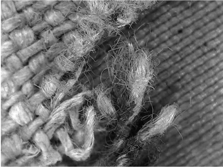
Εικ. 11. Λεπτομέρεια ελεύθερων ινών σε μεγέθυνση x18,72 στην εμπρόσθια όψη του αντιμήνσιου του Σωφρονίου Β'. (Πηγή: Χ. Παπαδάτος - Ζ. Ρέτση)
