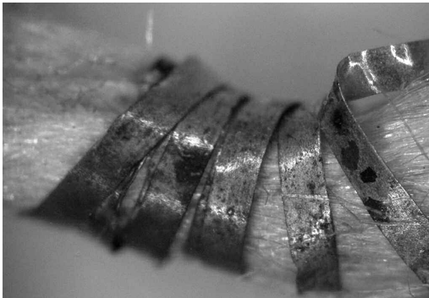
Εικ. 20: Ασημοκλωστή Δ21. Ίνα συνεχόμενης μεταλλικής περιέλιξης αργύρου (καθαρότητα: 100%).
